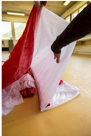
Pic. 69 Tendez le panneau #3 sur le côté. Diminuez le avec un pli
