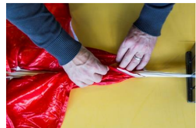
Pic. 88-89 Enroulez les tissus autour des suspentes
