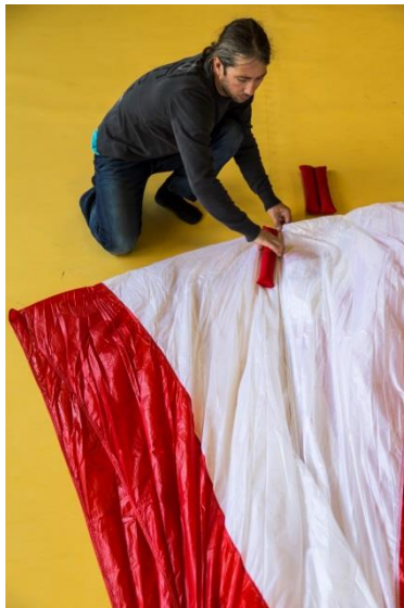
Pic. 57 Couture sur la suspente centrale
