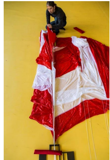
Pic. 75-77 Pliez les panneaux restants jusqu'au nez...
