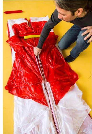
Pic. 85 Vérifiez que les suspentes soient bien claires ...
