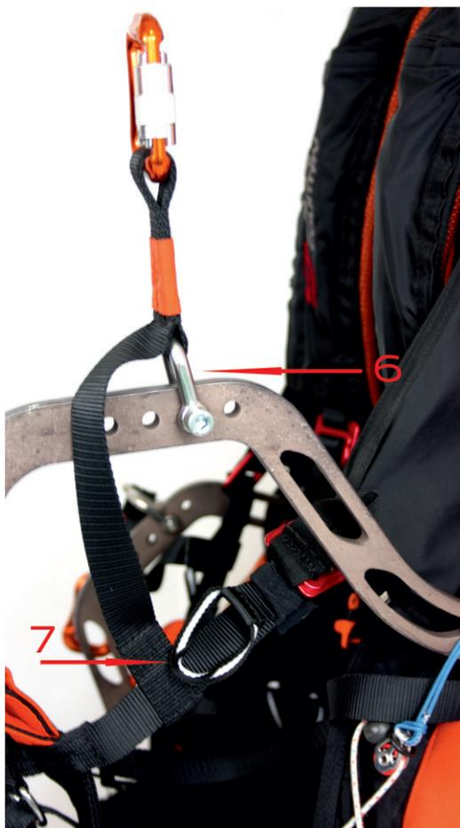
Регулировка центра тяжести осуществляется перестановкой карабина 6. Ремень 7 регулирует глубину подвески и так же несколько влияет на центровку. Нормальный угол отклонения установки назад должен быть в пределах 5-15 градусов.
