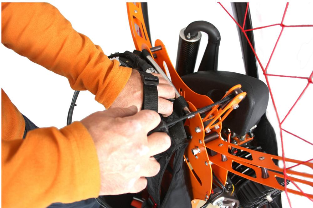
Плавнo выберете люфт механизма в устройстве ручного запуска двигателя, после чего интенсивно потяните шнур запуска двигателя. Правильно обогащенный двигатель должен запуститься после одной-двух попыток. Если двигатель не запустился после нескольких попыток, возможно вы переобогащали двигатель. В случае переобогащения двигателя, нажмите полностью РУД и несколько раз повторите запуск двигателя. Будьте внимательны и после запуска будьте готовы сразу отпустить ручку РУД.
