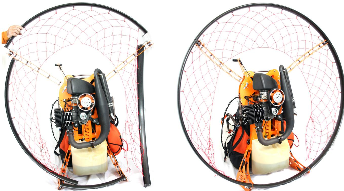
Зафиксировать ограждение с помощью эксцентрика 1. Усилие фиксации необходимо отрегулировать с помощью гайки 2.
