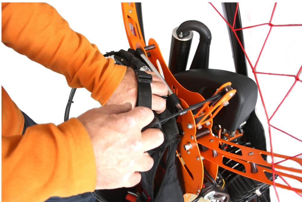
Плавно выберете люфт механизма в устройстве ручного запуска двигателя, после чего интенсивно потяните шнур запуска двигателя. Правильно обогащенный двигатель должен запуститься после одной-двух попыток. Если двигатель не запустился после нескольких попыток, возможно вы переобогатили двигатель. В случае переобогащения двигателя, нажмите полностью РУД и несколько раз повторите запуск двигателя. Будьте внимательны и после запуска будьте готовы сразу отпустить ручку РУД.
