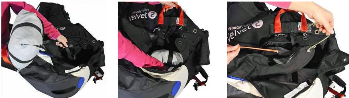
Протяните тонкие вспомогательные шнуры (например, из парапланерной стропы) через каждую эластичную петлю. Это поможет закрывать отсек.
