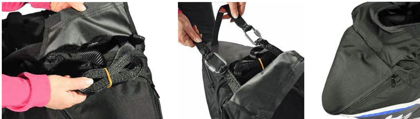
Два этих соединения должны быть выполнены с помощью резьбовых карабинов с прочностью на разрыв не менее 1400 кг. В любом случае важно убедиться, что длина фала достаточна для размещения запасного парашюта внутри отсека подвески, и что имеется достаточный запас свободного хода, чтобы извлечь парашют из отсека, не вызывая самопроизвольного раскрытия запасного парашюта при извлечении.
