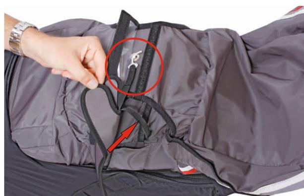
6. Mit dem Auslösesplint den Container sichern, Packnadel und Packschnur entfernen und Klarsichtabdeckung schließen (roter Kreis). Darauf achten, dass das Verbindungsband zum Rettungsgerät lang genug ist um den Splint sicher zu entriegeln (Pfeil).
