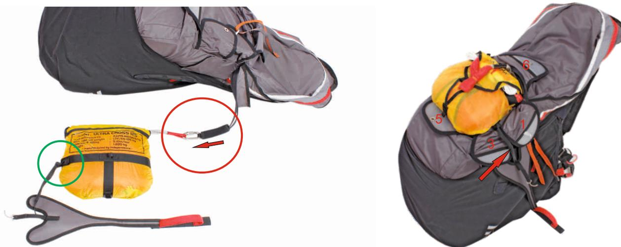
1. Verbindungsleine des Rettungsschirms mit der Verbindungsleine des Gurtzeuges einschlaufen oder mit einem Schraubglied (Festigkeit >2400 daN) verbinden. Verbindung (z.B. mit Neoprenschauch) gegen Verrutschen fixieren (roter Kreis). Auslösegriff am Innencontainer einschlaufen. Die Einschlaufung sollte am besten seitlich am Innencontainer erfolgen, damit eine sichere Auslösung gewährleistet ist (grüner Kreis)!
