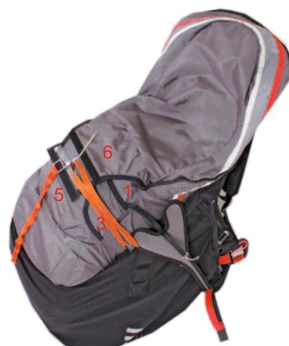
5. Containerklappe 5 und 6 schließen und mit Packnadel sichern.
