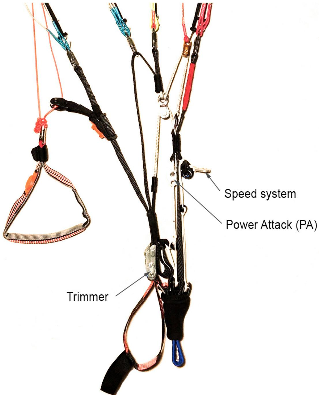
Figure: Élévateur Carve avec trimmer en position neutre, PA fusionne système et speed bare
