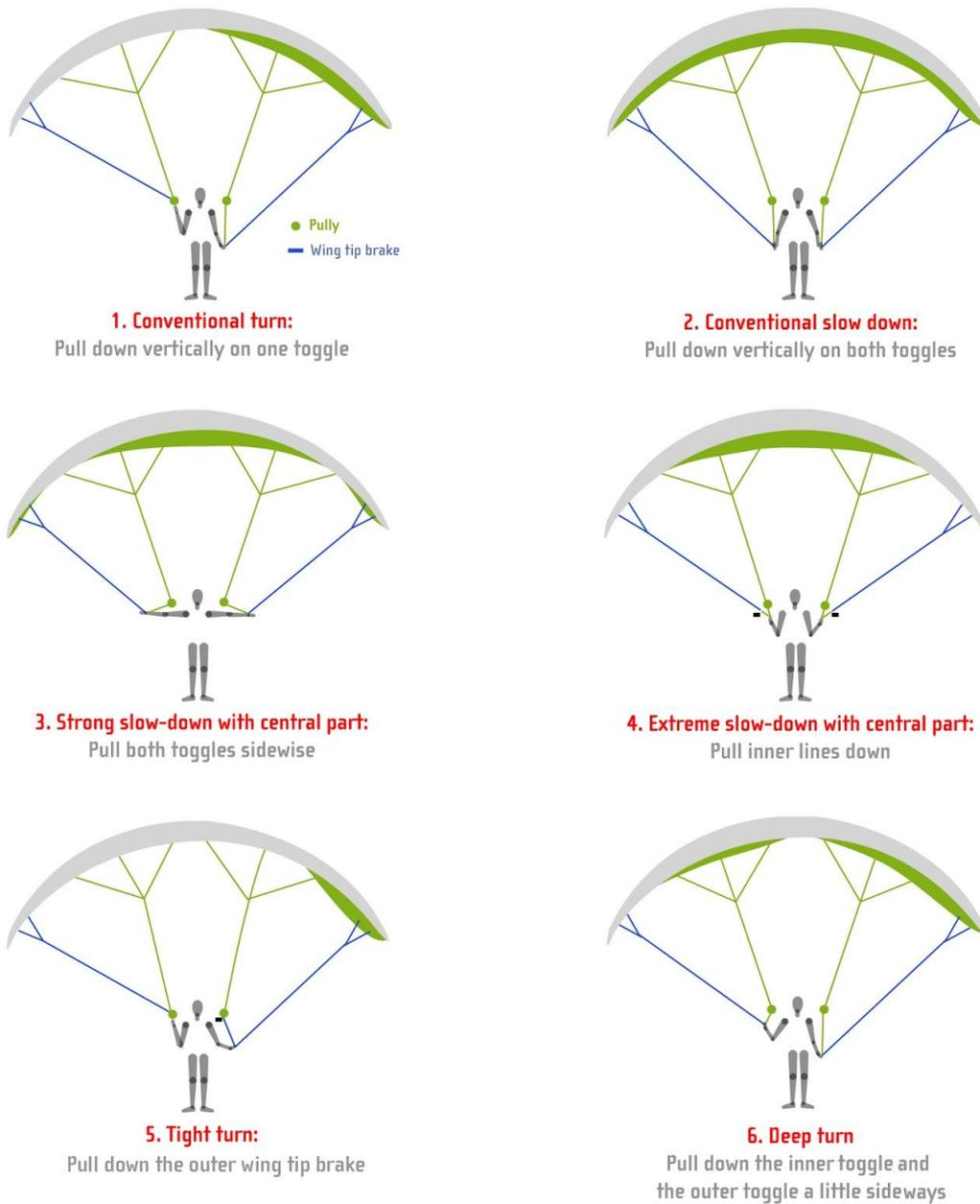
Figure: Modes de base de la Direction avec système 2D
