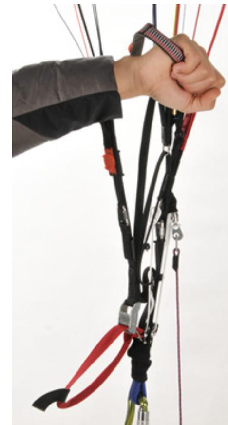
Figure: Volant avec la ligne de direction 2D externe seulement
